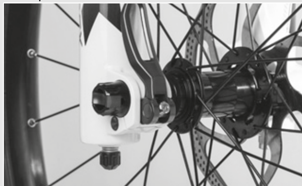
Figura 79: Ajuste de la fuerza de tensado del cierre rápido
