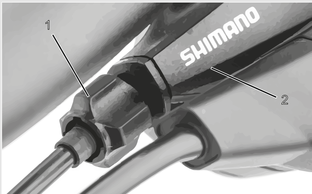
Figura 81: Casquillo de ajuste (1) del cambio de marchas accionado por cable de accionamiento con carcasa de la palanca de cambio (2), ejemplo
