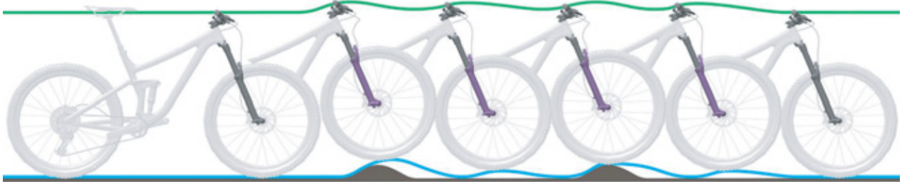
89. ábra: A teleszkópos villa túl gyors kirugózása
