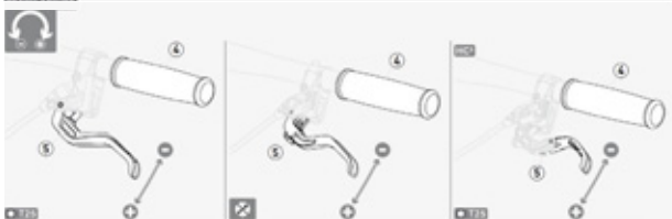
51. ábra: Magura tárcsafék fékkar markolási szélességének beállítása
