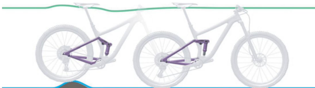
12. ábra: A hátsó lengéscsillapító optimális menetviselkedése egyenetlenségeknél
