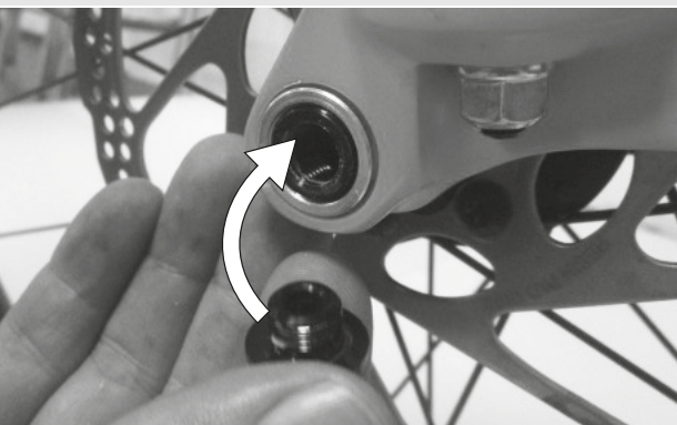
24. ábra: A gyorskioldó kar betolása a tengelybe
