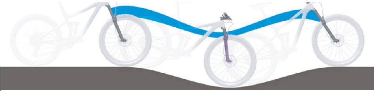
93. ábra: A teleszkópos villa túl puha rugózása hegymenetben
