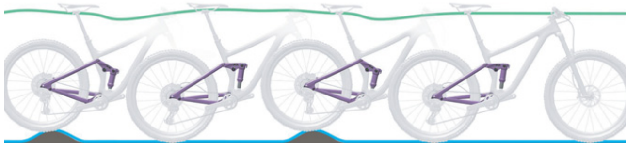
10. ábra: A hátsó lengéscsillapító optimális menetviselkedése
