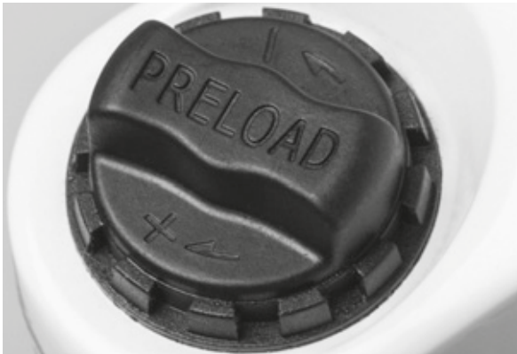
53. ábra: Az SAG (negatív rugóút) beállító kereke a teleszkópos villa koronáján
