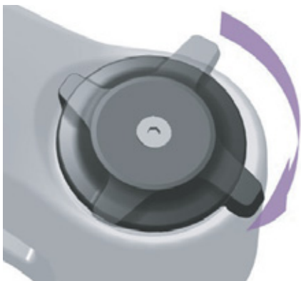
94. ábra: A nyomásfokozat-beállító keményebb beállítása
