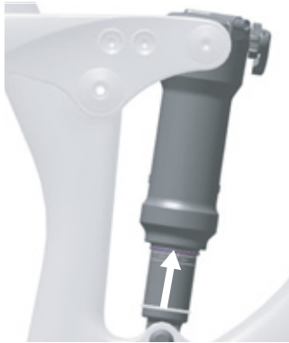
60. ábra: O-gyűrű eltolása a hátsó lengéscsillapítón
