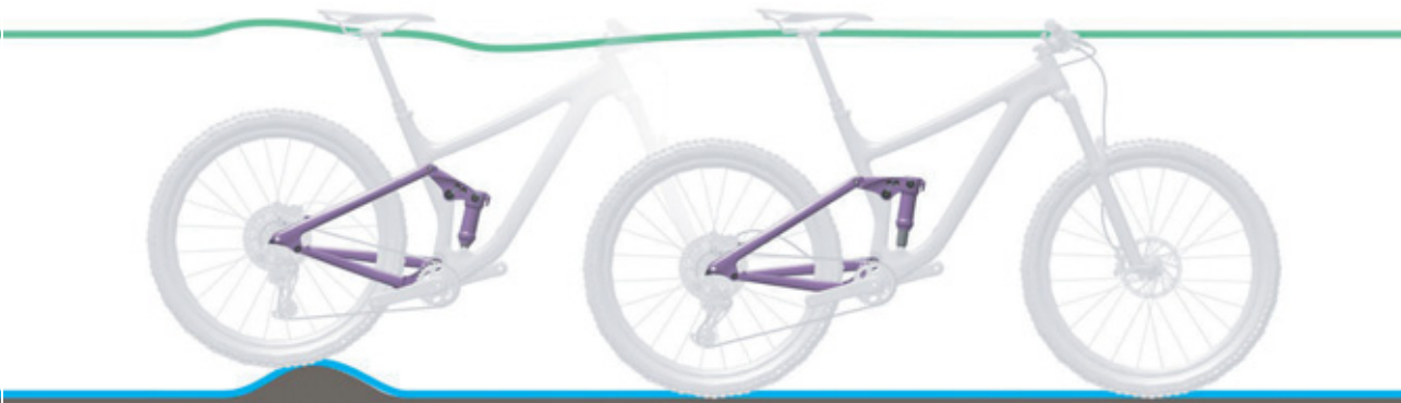
69. ábra: A hátsó lengéscsillapító optimális menetviselkedése egyenetlenségeknél
