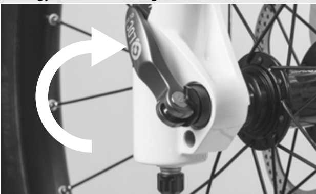
37. ábra: A gyorszár zárása
