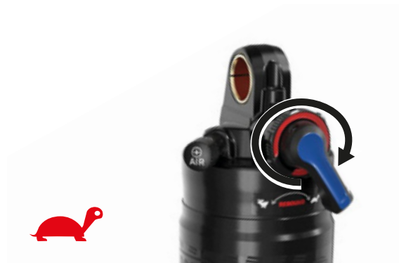
66. ábra: A kirugózási sebesség csökkentése
