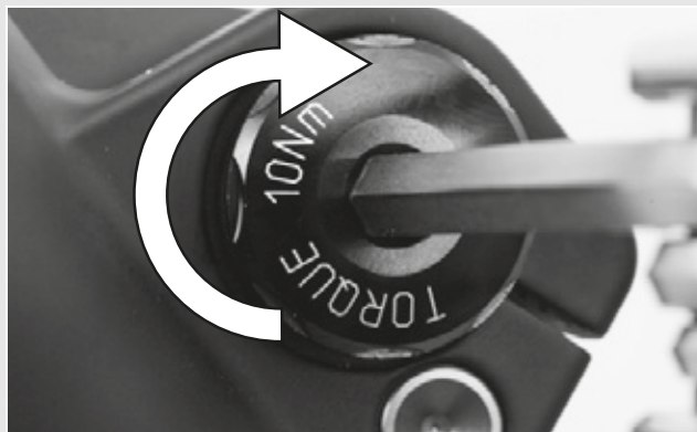
26. ábra: A behelyezett tengely meghúzása
