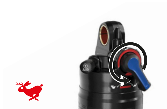
67. ábra: A kirugózási sebesség növelése
