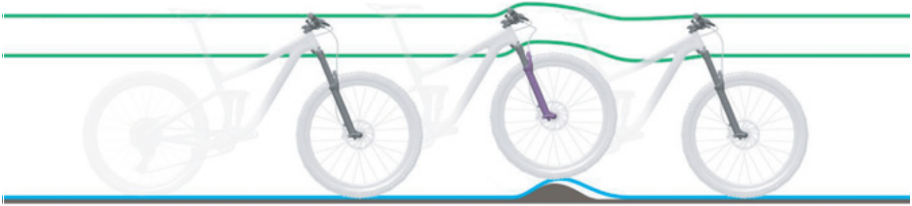
95. ábra: A teleszkópos villa túl kemény csillapítása egyenetlenségeknél
