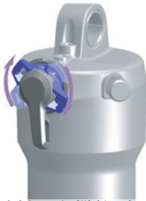
102. ábra: A nyomásfokozat-beállító keményebb beállítása
