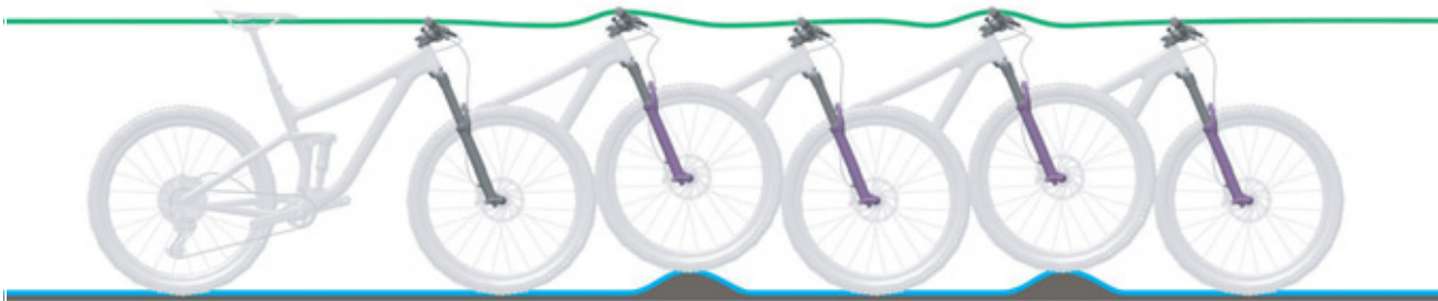
Paveikslėlis 61: Optimali šakių važiavimo charakteristika
