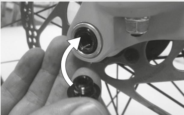
Paveikslėlis 24: Ekscentriko įstūmimas į ašį
