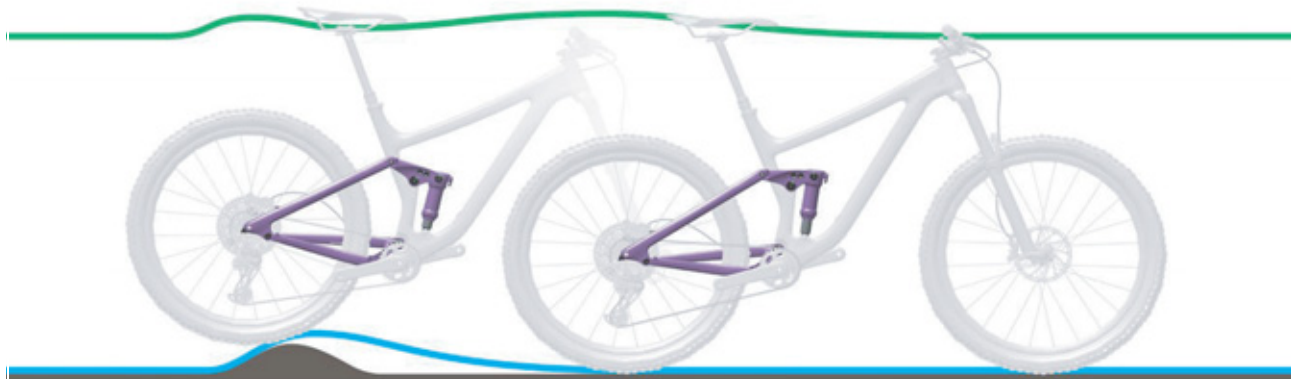
Paveikslėlis 103: Per kietas galinio amortizatoriaus amortizavimas nelygumuose
