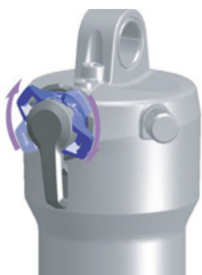
Paveikslėlis 102: Kompresijos reguliatorių nustatykite kietesnėje padėtyje
