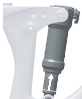
Paveikslėlis 60: Žiedinės tarpinės pastūmimas ant galinio amortizatoriaus
