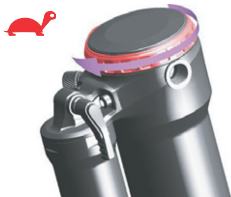
Paveikslėlis 98: Atšokimo pakopos reguliatoriaus pasukimas link vėžlio
