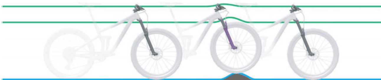
Paveikslėlis 7: Optimali šakių važiavimo charakteristika nelygumuose
