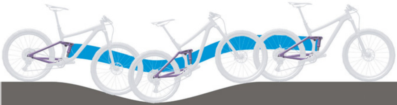
Paveikslėlis 68: Optimali galinio amortizatoriaus važiavimo charakteristika kalvotoje vietovėje
