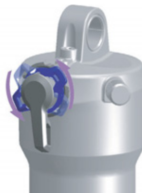
Paveikslėlis 72: Kompresijos reguliatorių nustatykite minkštesnėje padėtyje
