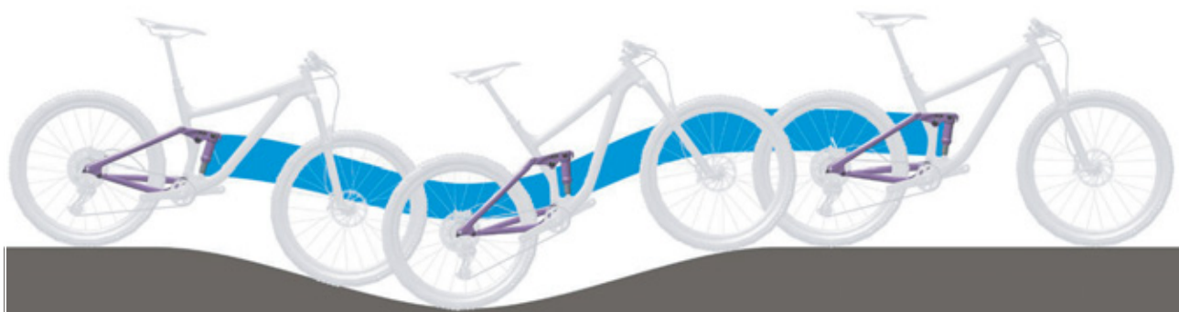
Paveikslėlis 11: Optimali galinio amortizatoriaus važiavimo charakteristika kalvotoje vietovėje
