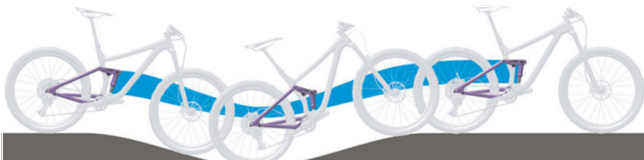
Paveikslėlis 101: Ant kalno galinio amortizatoriaus amortizavimas per minkštas
