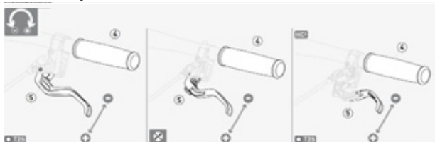
Paveikslėlis 51: „Magura“ diskinių stabdžių svirties atstumo iki vairo rankenos nustatymas
