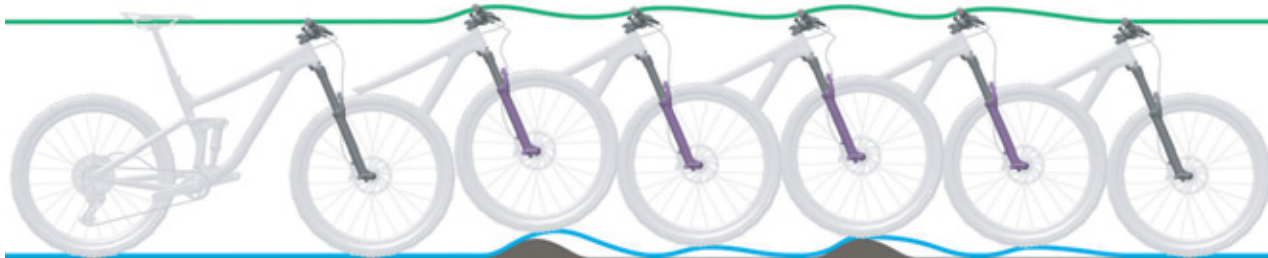
Paveikslėlis 89: Per greitas amortizuojančių šakių atšokimas
