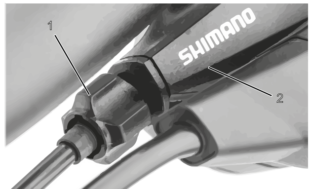
Paveikslėlis 86: Reguliavimo įvorė (1) vieno praėjimo kabeliu valdomam pavarų perjungimui su pavarų svirties korpusu (2), pavyzdys
