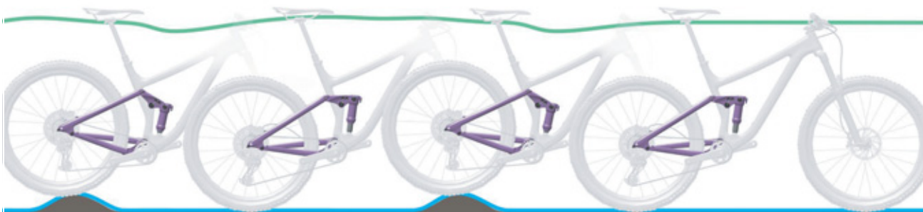
Paveikslėlis 62: Optimali galinio amortizatoriaus važiavimo charakteristika
