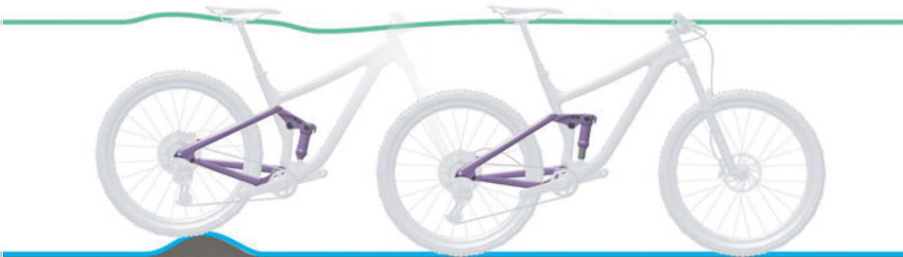
Paveikslėlis 69: Optimali galinio amortizatoriaus važiavimo charakteristika nelygumuose
