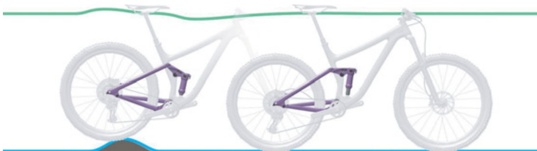
Paveikslėlis 12: Optimali galinio amortizatoriaus važiavimo charakteristika nelygumuose
