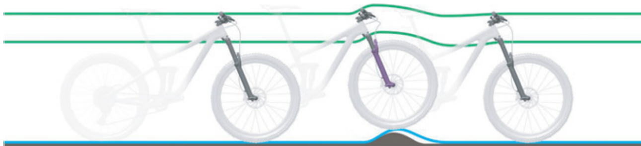
Paveikslėlis 95: Per kietas amortizuojančių šakių slopinimas nelygumuose
