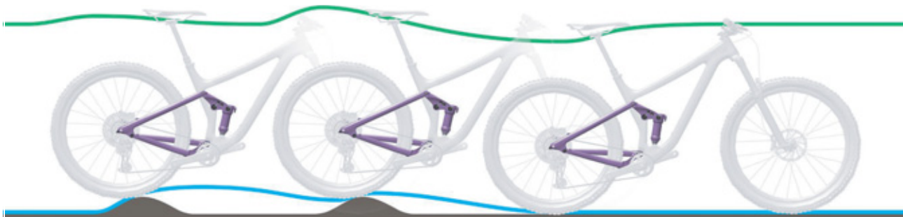
Paveikslėlis 99: Per lėtas galinio amortizatoriaus atšokimas
