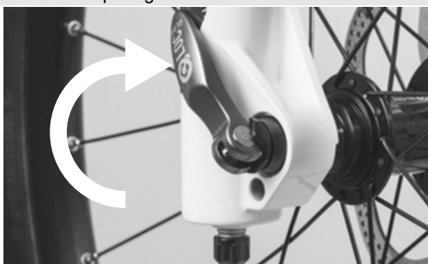
Paveikslėlis 37: Ekscentriko uždarymas
