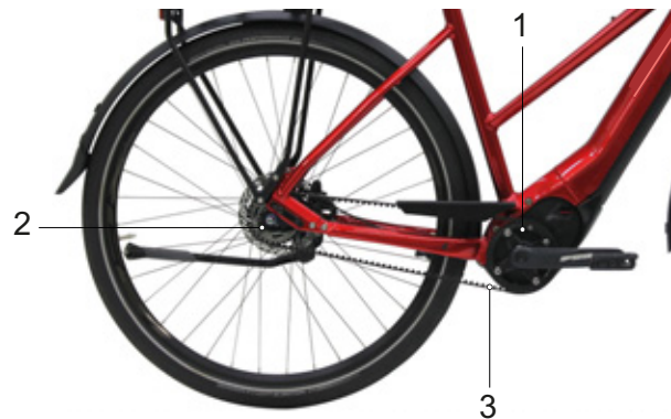
Illustration 47 : Schéma de l'entraînement à courroie
