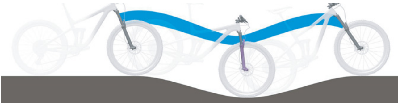
Illustration 132 : Comportement optimal de la fourche en terrain vallonné
