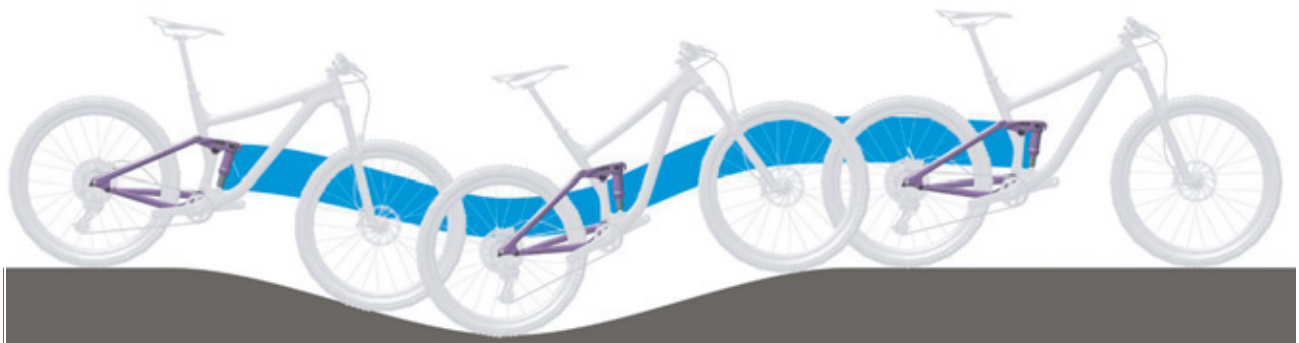
Illustration 6 : Comportement optimal de l'amortisseur arrière en terrain vallonné
