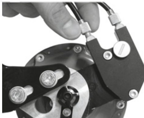
Illustration 212 : Sur les versions de moyeux ROHLOFF avec commande externe du changement de vitesse, le dispositif de réglage de la tension est situé sur le boîtier de câbles qui est placé sur le côté gauche.
