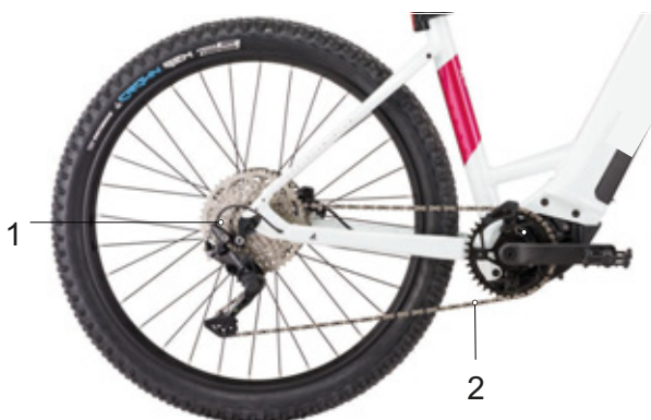
Illustration 46 : Schéma de l'entraînement à chaîne avec dérailleur
