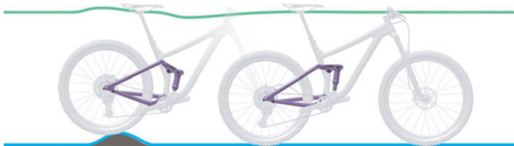
Illustration 138 : Comportement optimal de l'amortisseur arrière sur des irrégularités
