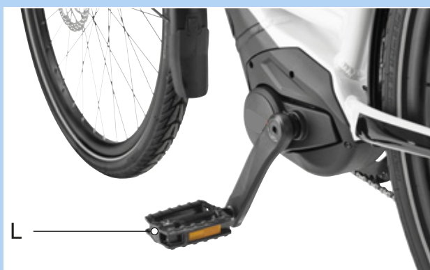
Illustration 98 : Pédale L dans le bras de manivelle gauche
