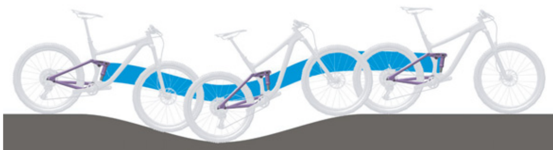
Illustration 137 : Comportement optimal de l'amortisseur arrière en terrain vallonné
