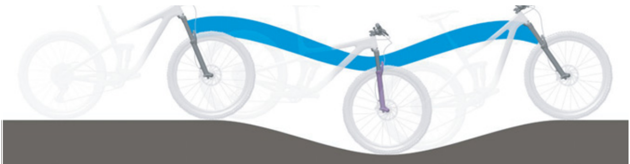
Illustration 17 : Comportement optimal de la fourche en terrain vallonné
