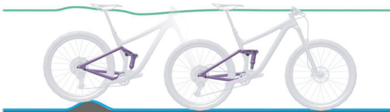
Illustration 165 : Comportement optimal de l'amortisseur arrière sur des irrégularités
