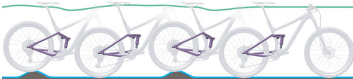
Illustration 136 : Comportement optimal de l'amortisseur arrière
