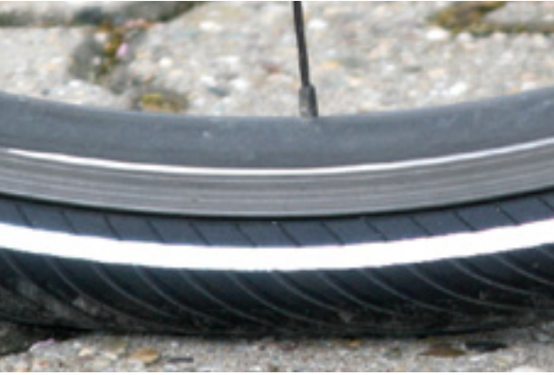
Illustration 124 : Pression correcte. Le pneu se déforme à peine sous le poids du corps.
